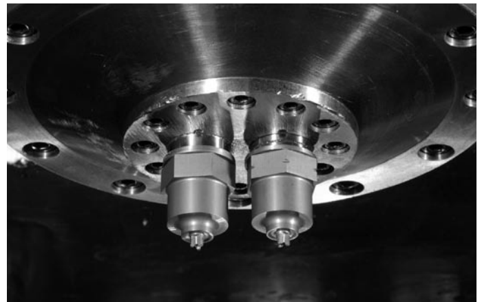
Twin-stirの試作機の頭部アセンブリ
