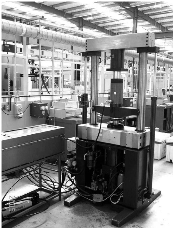
図1. 小さな容器に繰返し圧力試験を施す
