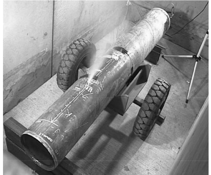
図2. パイプの破裂試験
