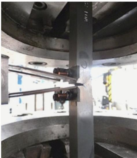
破壊靱性を調べるためにノッチの口に2つのクリップゲージを取り付けた、SENT試験中の試験片
