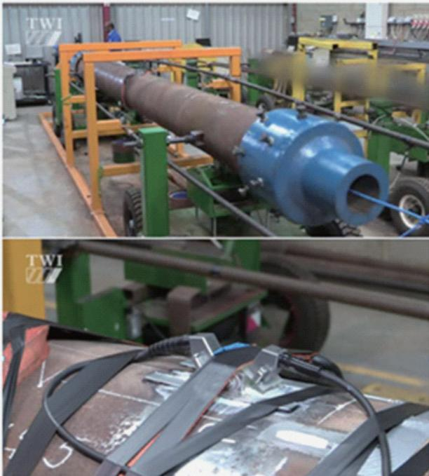
図1：以下に示した修正済み2本プローブシステムによるフルスケールの共振試験
