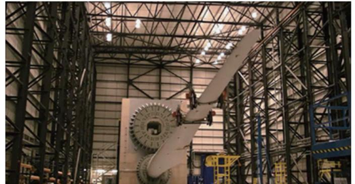
長さ45.7mのタービンブレードの試験
