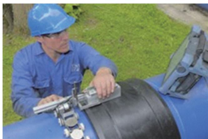
EF継手の検査で使用されているPolyTest TWIは、ポリエチレン(PE)パイプのEF継手とBF継手の欠陥を確実に検出できる新しい検査装置を発表しました。
