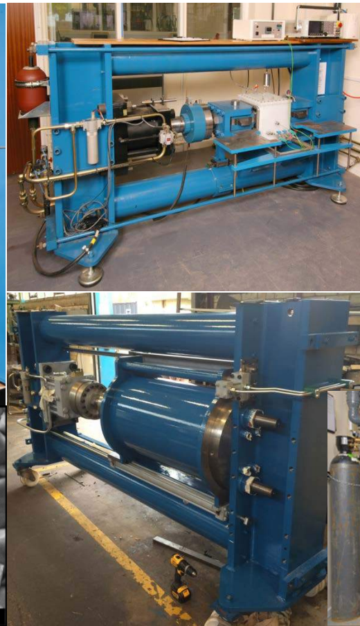
HPHT corrosion fatigue (dynamic)
